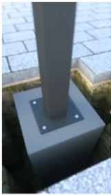
Kurze Stütze | Stützen werden mit einer Fußplatte angefertigt. Die Fußplatte wird dann auf ein vorhandenes Fundament geschraubt. Hierzu werden spezielle Stahl-Dübel in das Fundament eingesetzt.
