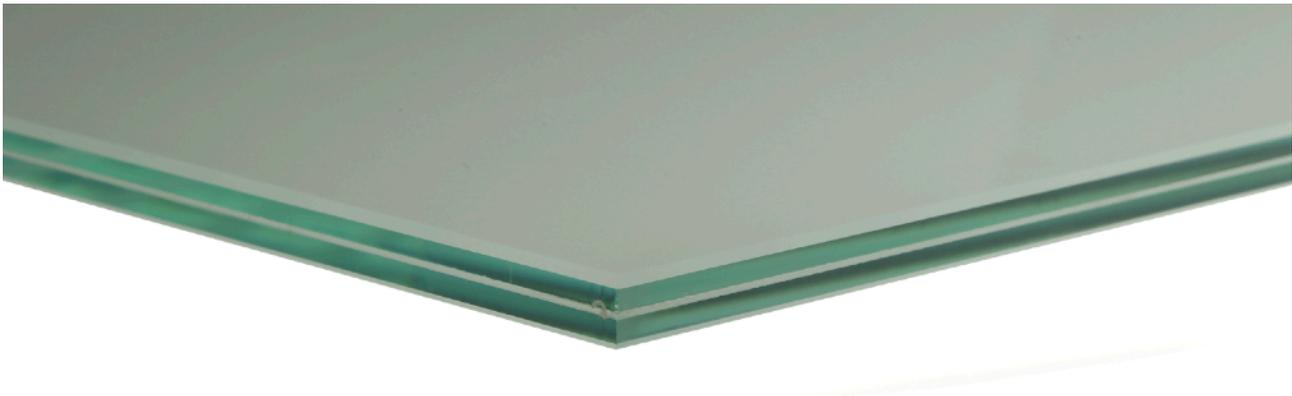
Bei den von Carportmaster für die Dachdeckung eingesetzten Glasscheiben aus Sicherheitsglas handelt es sich um Verbundsicherheitsglas mit teil-vorgespannten Scheiben, VSG/TVG. Bei dieser Ausführung werden zwei Glasscheiben mittels einer durchsichtigen Trägerfolie verklebt.
