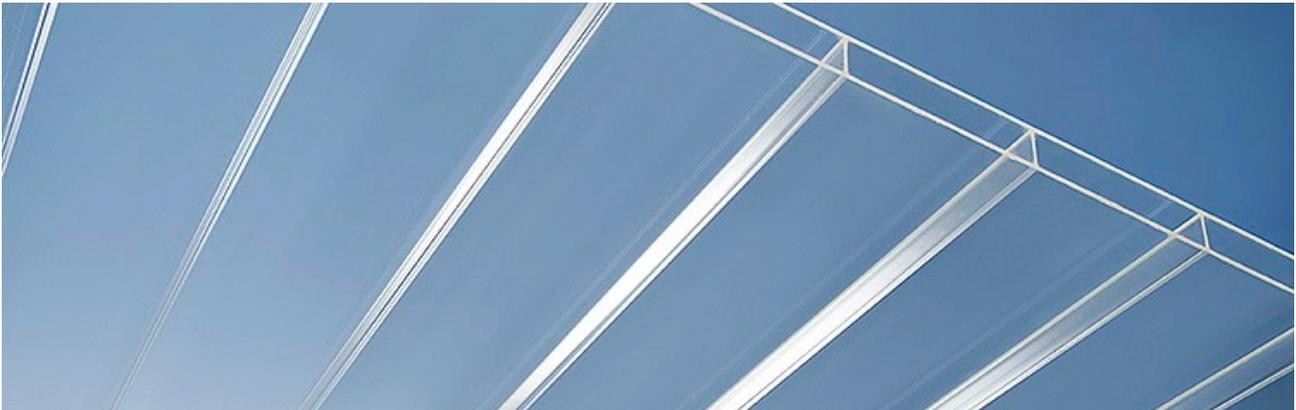
Plexiglas®-Doppelstegplatten sind Algenbewuchs reduzierende, sehr lichtdurchlässige und dauerhaft witterungsbeständige Platten aus schlagzäh modifiziertem Acrylglas (Polymethylmethacrylat, PMMA). Für die Bedachung eines Carports sind Plexiglas® Resist Stegplatten in den Farben farblos (86%) und weiß (74%) lieferbar.
